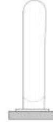
سازه طره ای با جرم گسترده سیلو و دودکش و ظروف قائم روی پدستال R_{ii} = 3 یا 2
