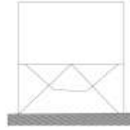
بونکر یا کندو روی پایه ها با یا بدون مهاربندی R_{ii} = 3 یا 2
